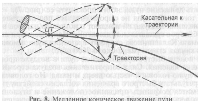
Рис. 8. Медленное коническое движение пули
