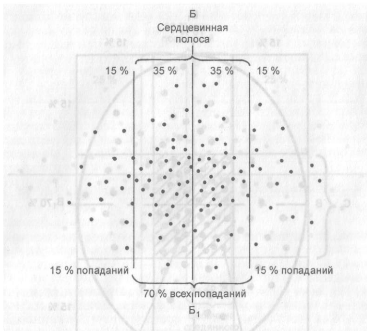
Рис. 28. Определение величины сердцевинной полосы по боковому направлению графическим способом
