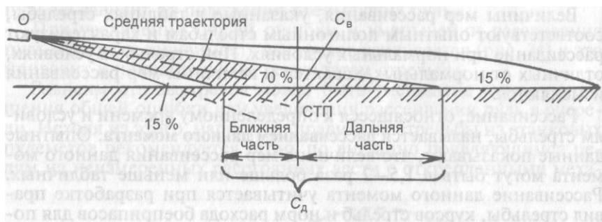
Рис. 35. Несимметричность рассеивания по дальности при стрельбе на близкие расстояния
